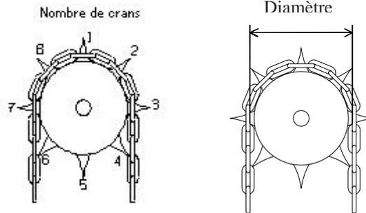
Mesurez le diamètre effectif de la poulie, en excluant les crans, en mm.
