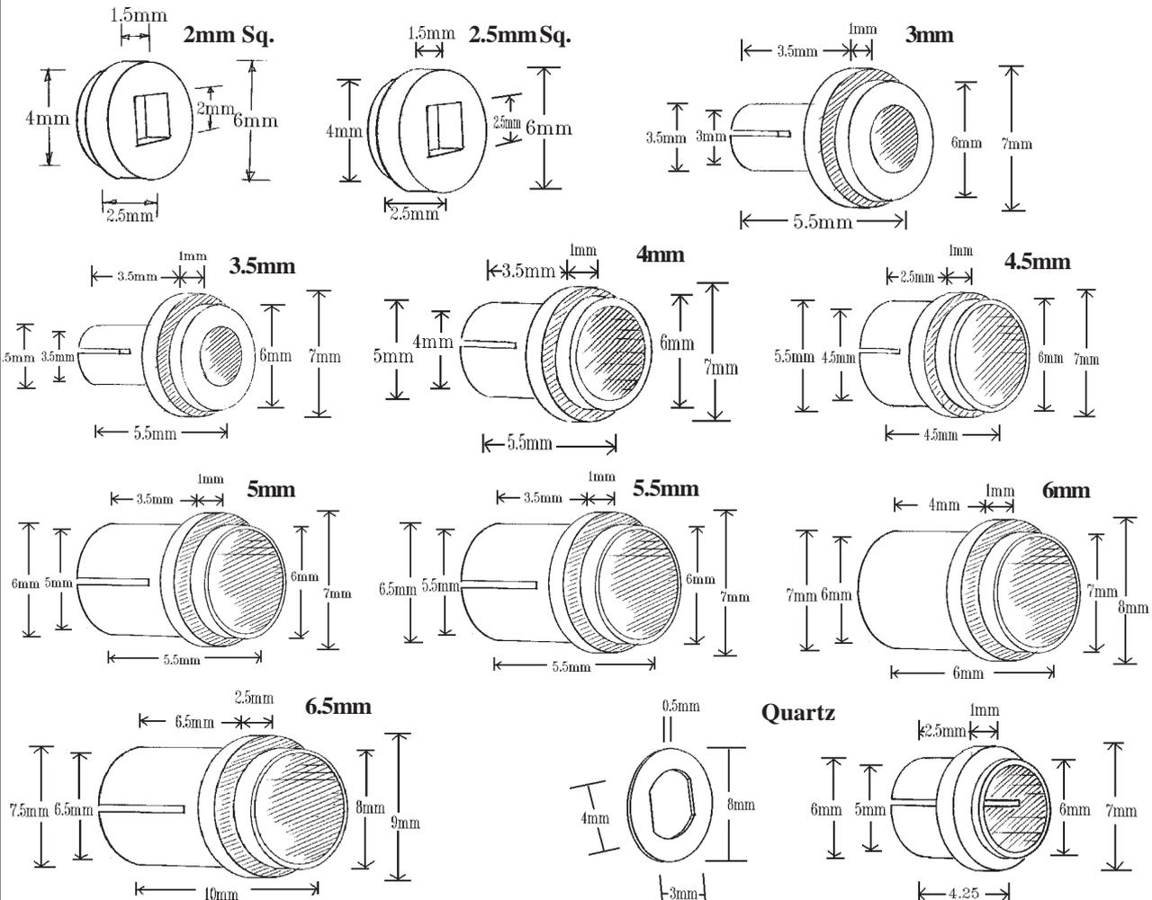
On nous demande souvent de l'aide pour la sélection des bouchons et des équarrissoirs lors de la réparation d'horloges. Ce document suppose que le client bouchonne à la main sans l'aide d'autre outil quelconque.
