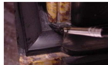
Les parties difficiles d'accès se font au pinceau
